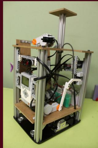
Marty est le robot de Thomas et Victor. C'est le robot ayant les plus grandes dimensions. Sa structure en trois étages est montée sur une base roulante en PVC avec 2 roues de roller pour l'adhérence.
